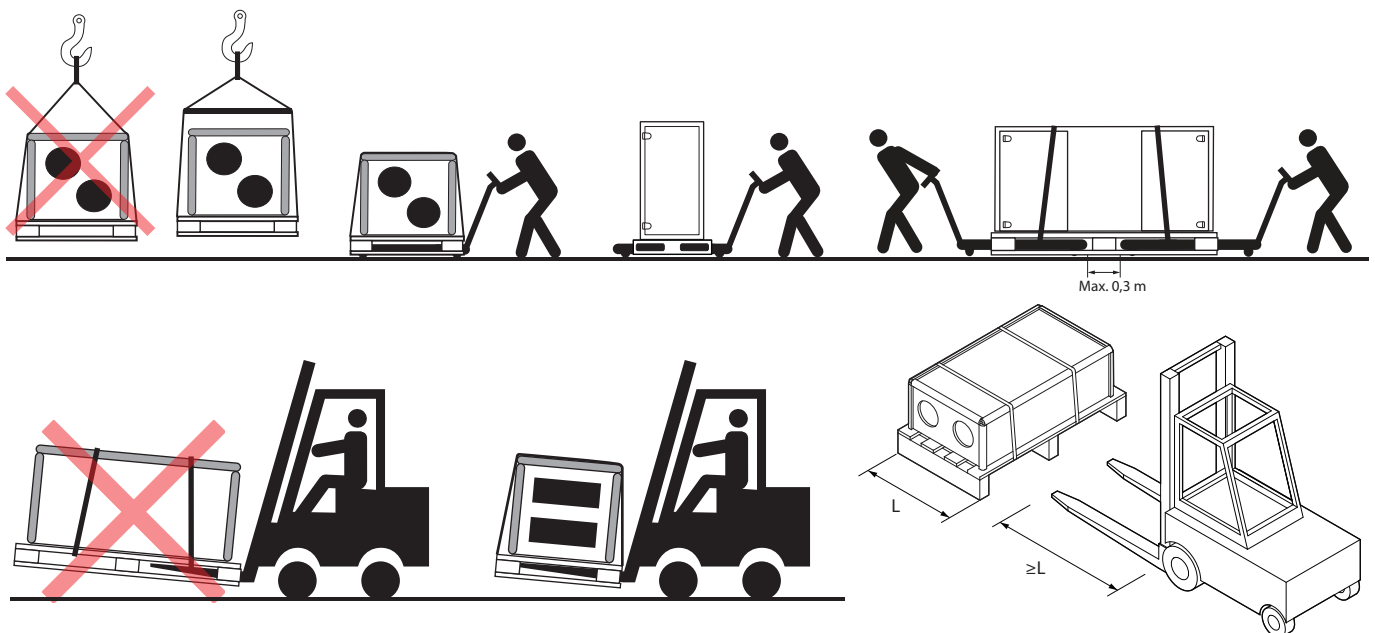
Obr. 5: Příklad přepravy jeřábem, vysokozdvizným vozíkem nebo na ručním vozíku
